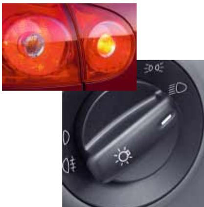
**Wegen der starken Blendwirkung darf die Nebelschlußleuchte lediglich bei Sichtweiten unter 50 m eingeschaltet werden.**
