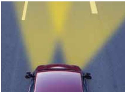
Mit der Leuchtweitenregulierung können die Scheinwerfer dem Belastungszustand des Fahrzeugs stufenlos angepaßt werden, damit der Gegenverkehr nicht geblendet wird. Gleichzeitig werden durch die richtige Scheinwerferstellung für den Fahrer optimale Sichtverhältnisse geschaffen.
