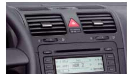
Außerdem blinkt im Druckschalter eine Kontrollleuchte mit, sowie bei eingeschalteter Zündung die beiden grünen Kontrollleuchten für die Blinkleuchten.
